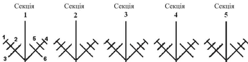
Рис. 1. Схема розміщення робочих органів ротаційного підгортача
