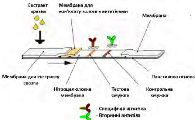
Рисунок 9.2 Схема будови тест-смужки для латерального проточного імуноаналізу (імунохроматографічний швидкий тест)
